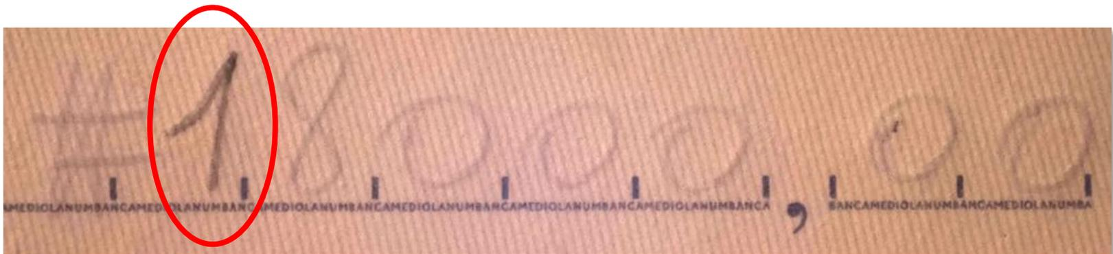
Differenza di inchiostri rilevata con IR a 750 nm
